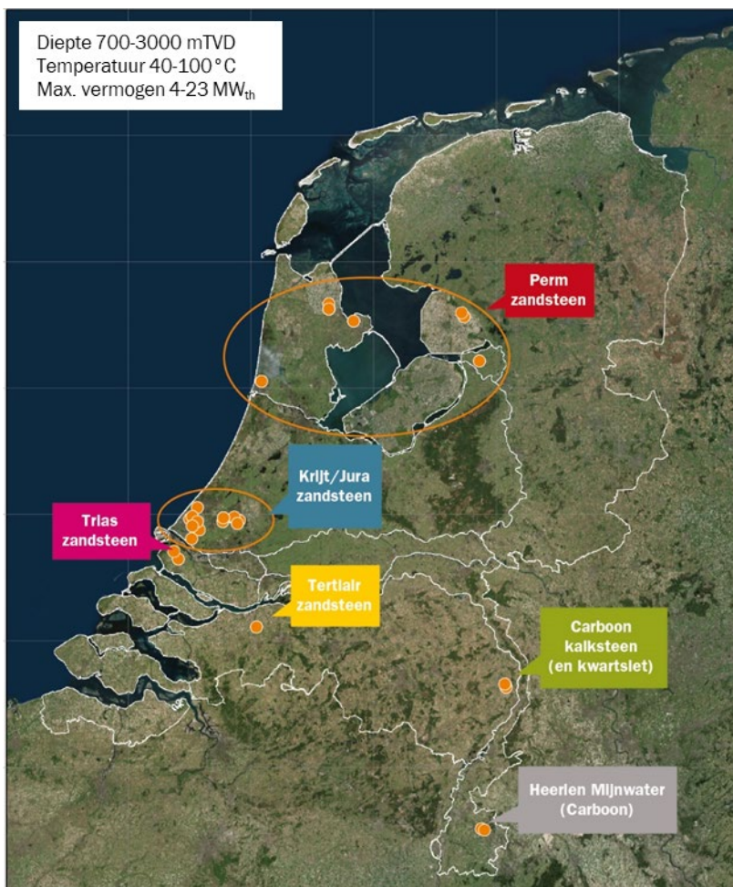
Figuur 3 - Overzicht van geothermiedoubletten in Nederland, met de ouderdom van de aquifer waaruit ze produceren. Bron: confidentiële data Geologische Dienst Nederland 9 en jaarverslag Delfstoffen en aardwarmte in Nederland 10 .
